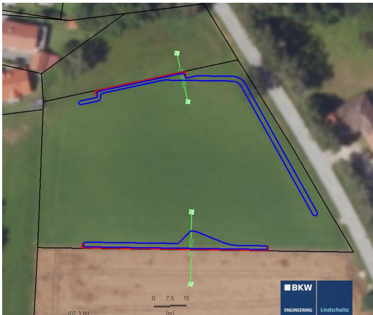
Abbildung 17: Lage der Sickermulden (blau), Stützmauern (rot), Flurstücksgrenzen (schwarz, Auswahl) und Lage der Profilschnitte (hellgrün).
